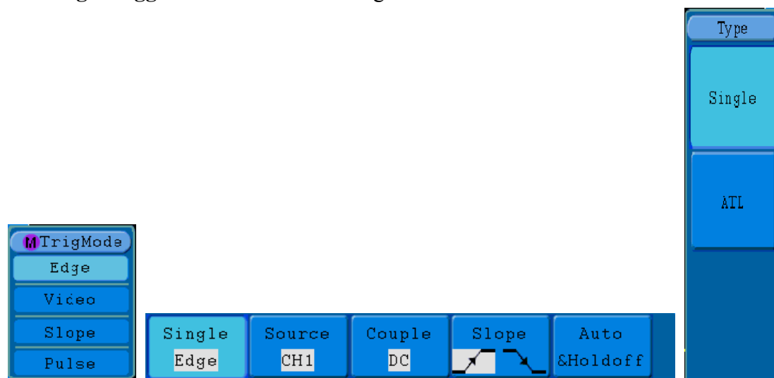
Fig. 5-17 Edge trigger menu
